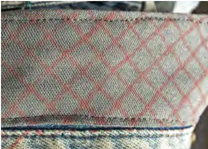
Proceso de marcar la grilla en la tela a través de lápiz borrrable.
